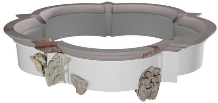
Fig. 22: Proposta di ricostruzione della sezione sommitale della tazza del fonte
